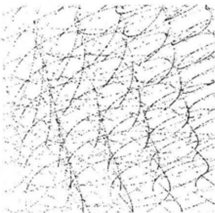
Esperimento dell'autore. Visualizzazione di traiettorie di punti di un meccanismo in movimento.
